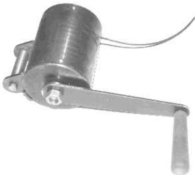
Рис. 4. Ручная лебедка. Общий вид.
