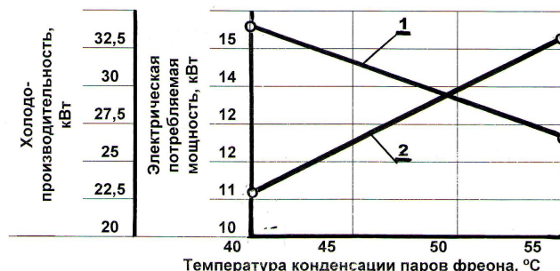
Рис. 1. Зависимость холодопроизводительности и расхода электроэнергии на привод компрессора от температуры конденсации паров фреона: линия 1 – зависимость холодопроизводительности компрессора от температуры конденсации паров фреона; линия 2 – зависимость расхода электроэнергии на привод компрессора от температуры конденсации паров фреона
