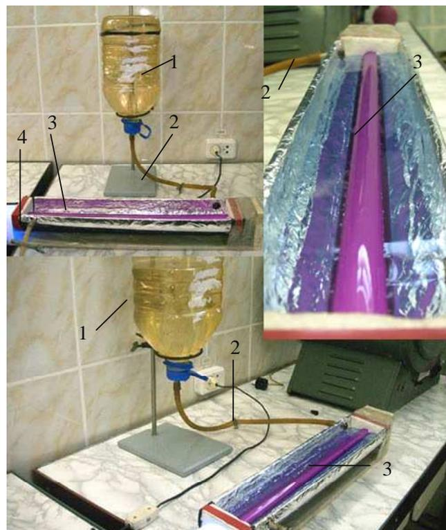
Рис. 1. Установка для обработки воды ультрафиолетовым светом: 1 – резервуар исходной воды; 2 – подача исходной воды на обработку; 3 – ультрафиолетовая лампа низкого давления мощностью 36 Вт; 4 – отвод обработанной воды.
