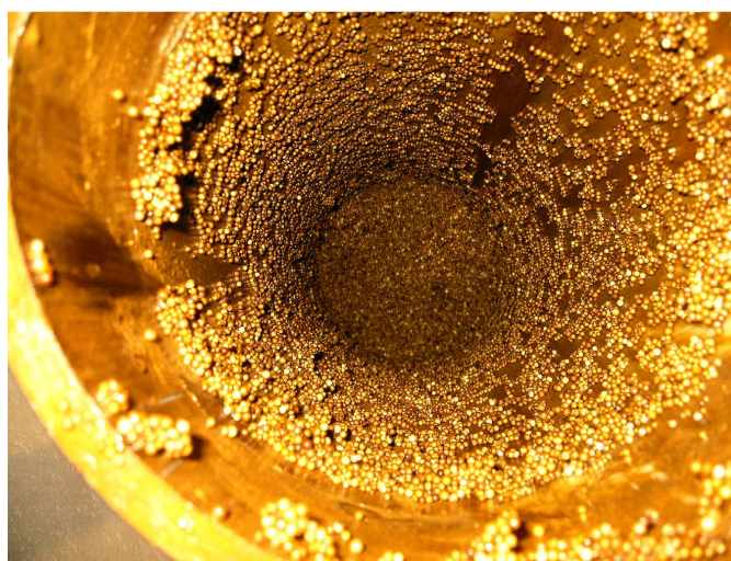
Рис. 8. Общий вид загрузки после непрерывной работы в течение 40 часов
