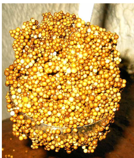
Рис. 7. Вспененная загрузка, покрытая окислами железа
