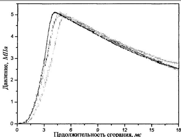
Рис. 5. Зависимость давления от продолжительности сгорания водородно-воздушной смеси (смесь 5) при начальном давлении в модельной камере сгорания 0,735 МПа
