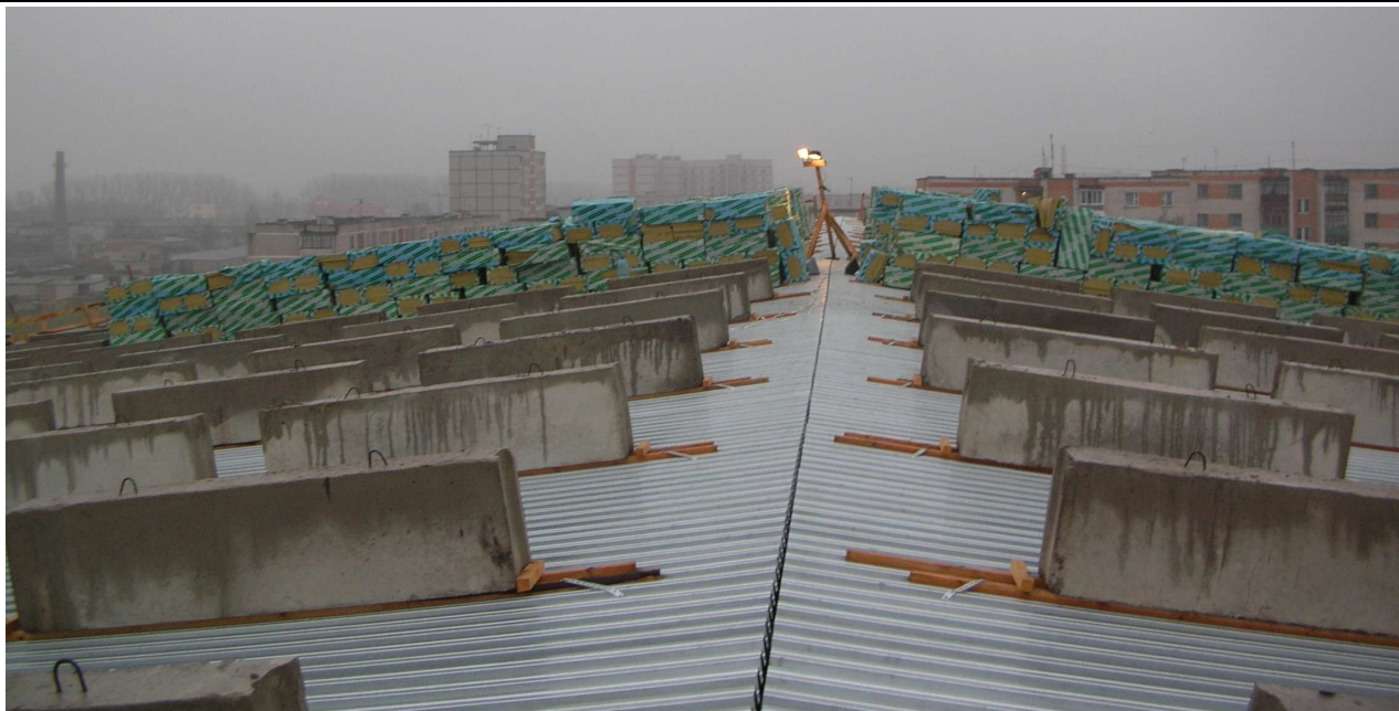
Рис. 8. Загрузка покрытия испытательной нагрузкой
