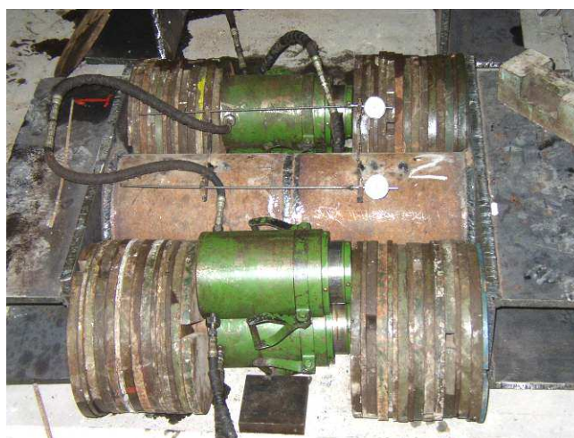
Рис. 7. Стенд для испытания стыка затяжек.
