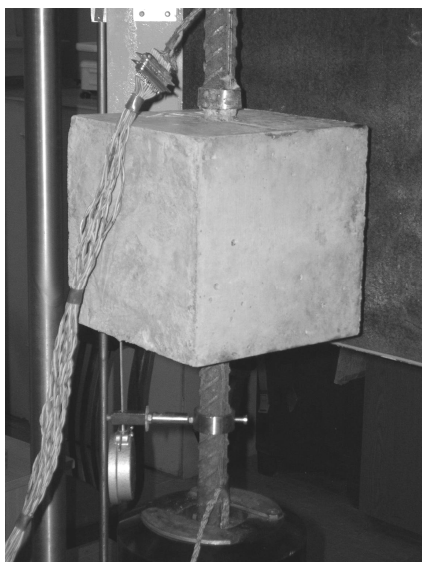
Рис. 5. Экспериментальный образец в разрывной машине ИР 5145-500-11.
