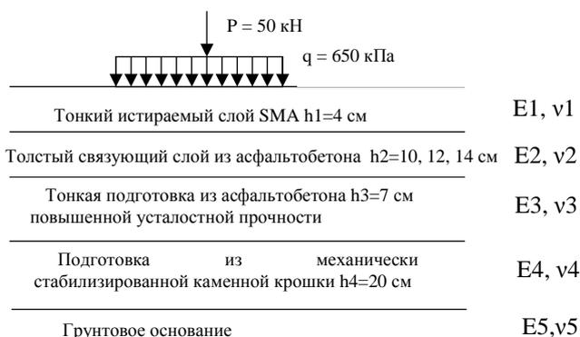
Рис. 6. Конструкция покрытия типа „perpetual”
