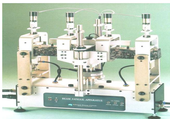
Рис. 3. Устройство для испытаний на усталостную прочность
