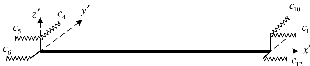
Рис.3. Угловые упругие связи пространственного КЭ
