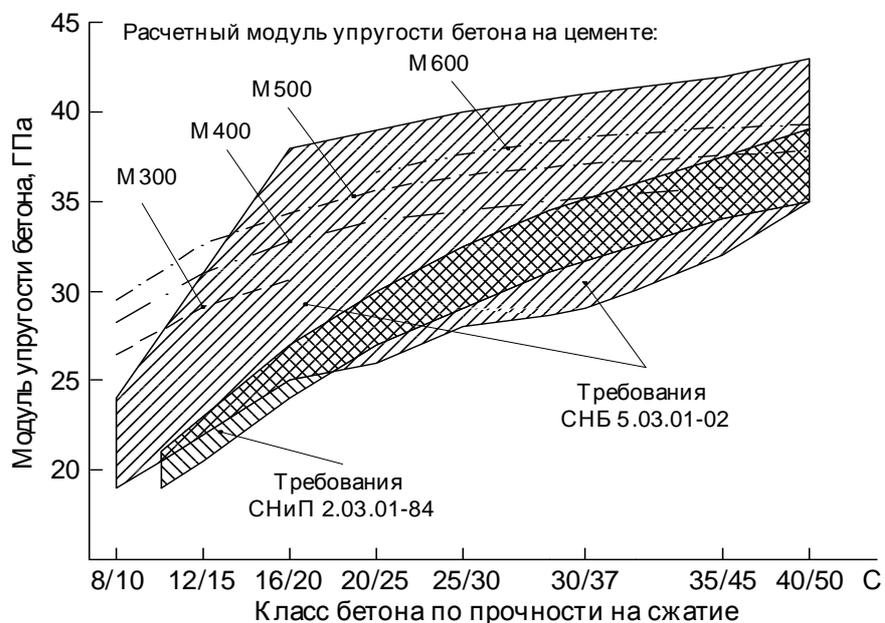
Рис. 2. Зависимость модуля упругости бетона от класса бетона по прочности на сжатие (С)
