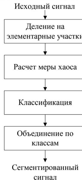
Рис. 1. Сегментация сигнала
