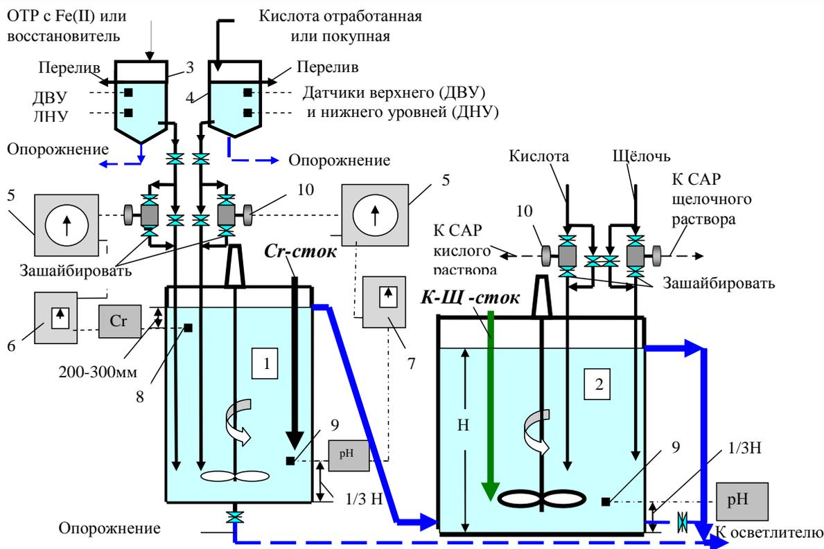
Рис. 1. Вариант обвязки автоматизированных реакторов восстановления Cr<sup>6+</sup> и нейтрализации всех видов сточных вод
