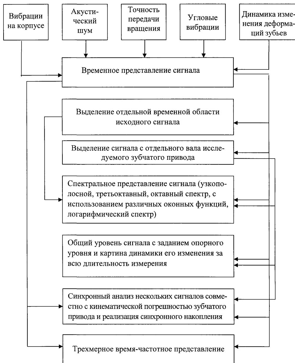
Рис. 1. Возможности аппаратно-программного комплекса для диагностики зубчатых передач
