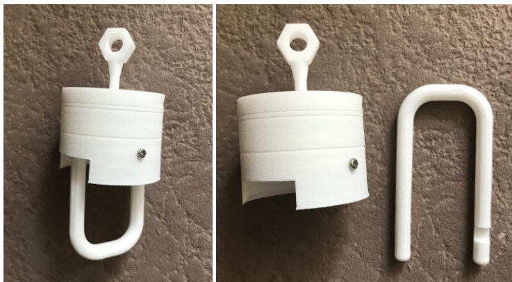
Рисунок 2. Модель замка навесного, выполненная на 3D принтере
