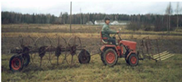
Рисунок 1. Малогабаритный агрегат для уборки сена
