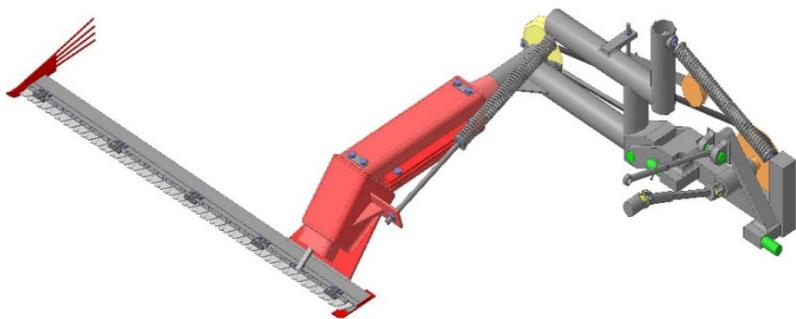
Рисунок 7. 3D-модель малогабаритной косилки
