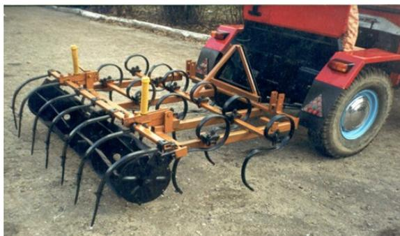
Рисунок 2. Малогабаритный почвообрабатывающий агрегат
