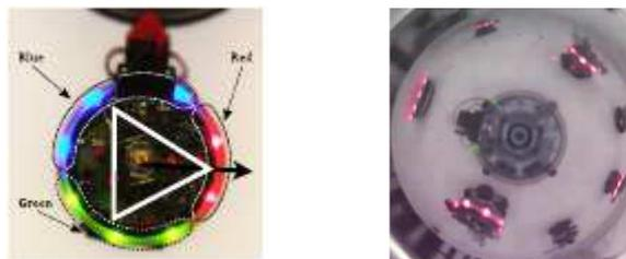
Рис. 1. Триангулярный паттерн, формируемый светодиодами робота
