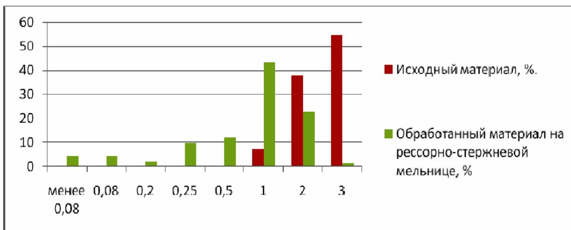
Рисунок 6. Диаграмма обработки клинкера на рессорно-стержневой мельнице
