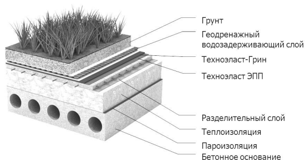
Рисунок 14 – Конструкция зеленой кровли
