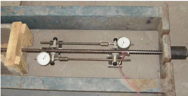
Рис. 2. Контроль уровня натяжения арматуры с помощью индикатора часового типа
