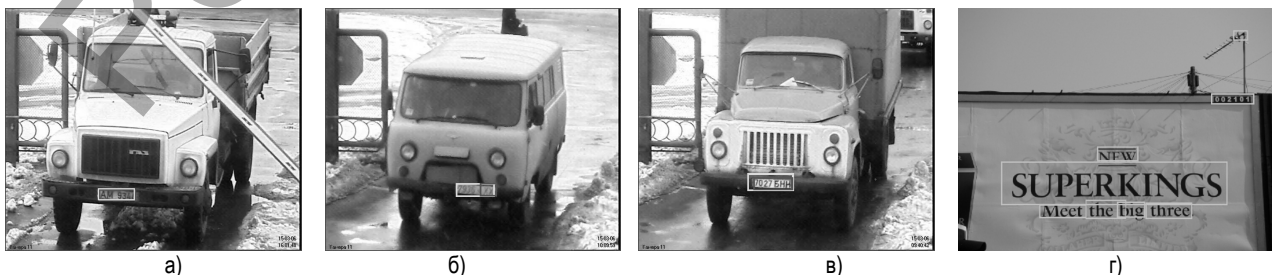
Рисунок 5 – Примеры результатов работы модуля детектирования текста: точной (а) ( \text{recall} = 0,92 , \text{precision} = 0,96 ), частичной (б) ( \text{recall} = 0,36 , \text{precision} = 0,86 ), избыточной (в) ( \text{recall} = 1,00 , \text{precision} = 0,55 ) локализации номеров, а также слов базы ICDAR 2013 (г)
