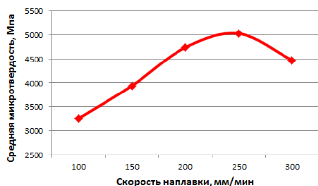
Рисунок 4 – Зависимость средней микротвердости в валике из бронзы ПГ-19М-01 от скорости наплавки
