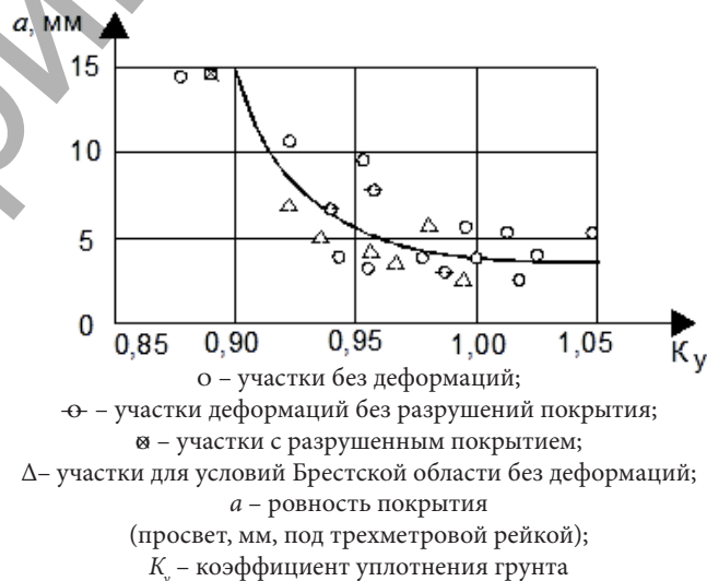
Рисунок 1. Зависимость ровности покрытия от степени уплотнения грунтов земляного полотна
