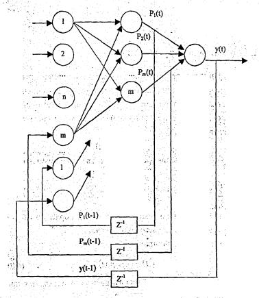
Рис. 4.3. Архитектура рекуррентной сети с обратными связями от нейронов скрытого и выходного слоя
