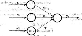
Рис. 2.14. Представление порогового значения в виде синаптической связи.
