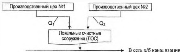
Рис.3. Схема водоотведения промышленных сточных вод Q_1, Q_2 – производственные сточные воды различного состава
