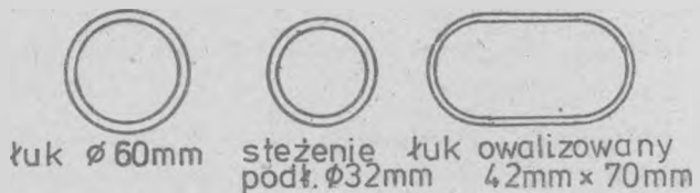
Rys. 2. Przekroje elementów konstrukcyjnych
